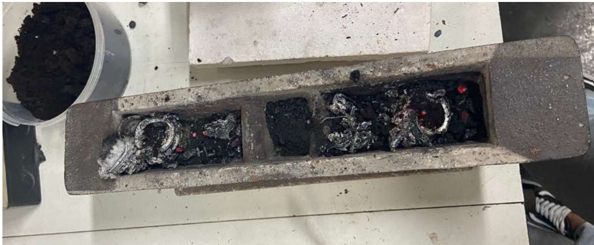
Figura 23: Lingoteira da fundição com atmosfera de borra de café (Autor, 2021)
