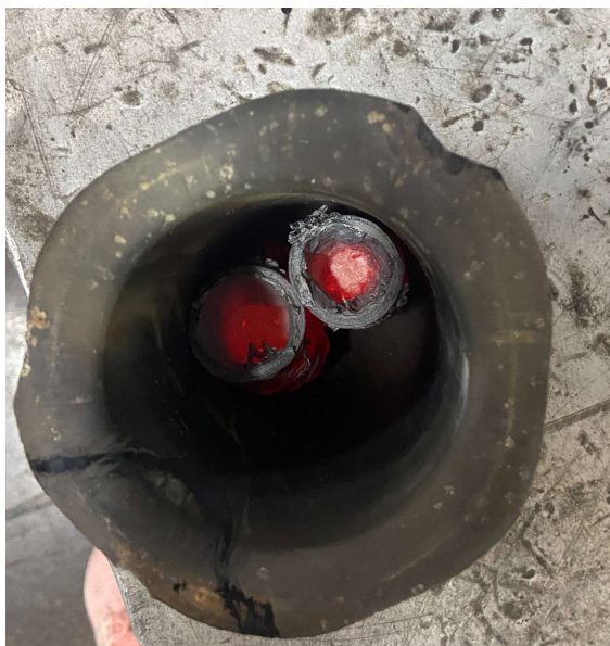
Figura 18: Cadinho com cápsulas de alumínio ao sair do forno (Autor, 2021)
