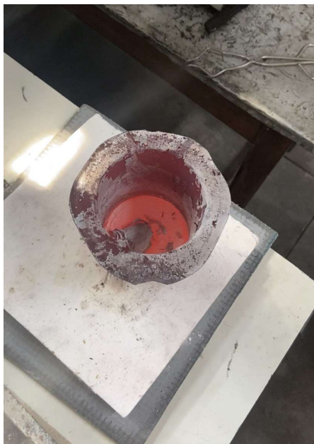
Figura 20: Cadinho com cápsulas em banho ao sair do forno (Autor, 2021)
