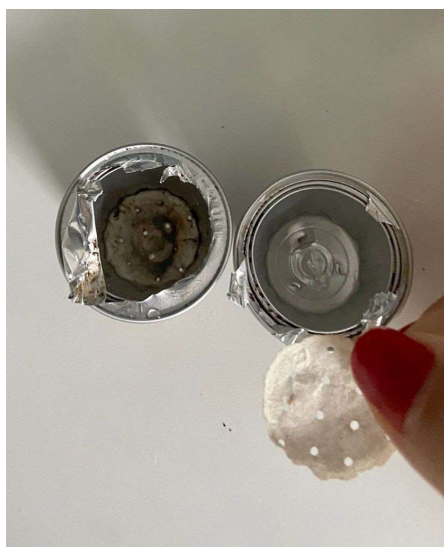
Figura 16: Na esquerda cápsula de alumínio com filtro de papel em no seu interior e na direita a cápsula e o filtro separados (Autor, 2021)
