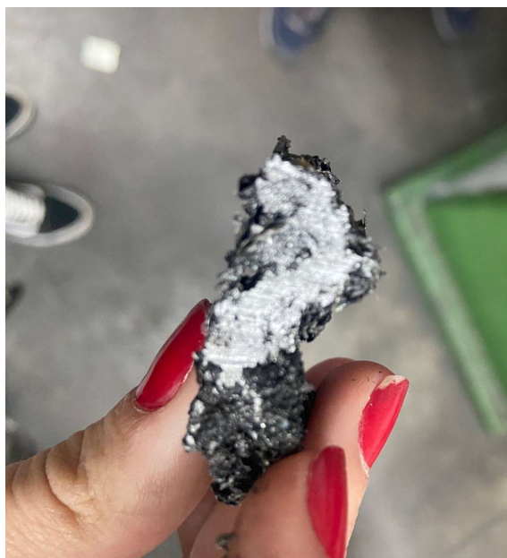
Figura 21: Escória da fundição com banho (Autor, 2021)
