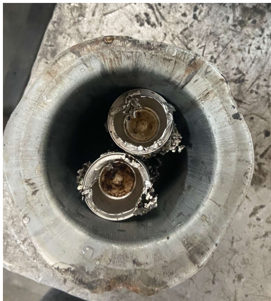
Figura 15: 20 cápsulas de alumínio acomodadas no cadinho (Autor, 2021)
